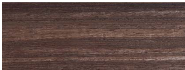
Lame de Padouk après environ 1 mois d'exposition.
